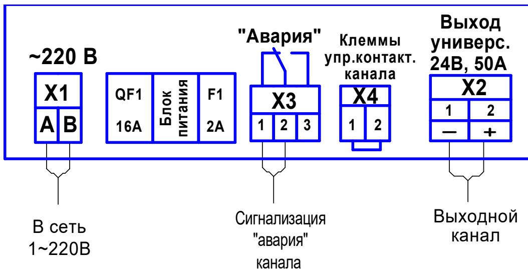
Клеммы X4 установлены для управления выходным каналом.
