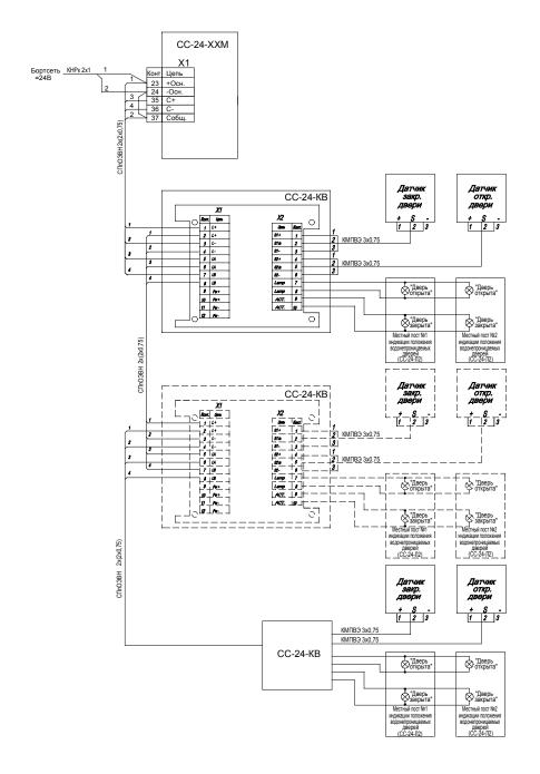
**Примечание:** Поставка датчиков и светосигнальной аппаратуры для местного поста индикации положения водонепроницаемых дверей оговаривается при заказе.
