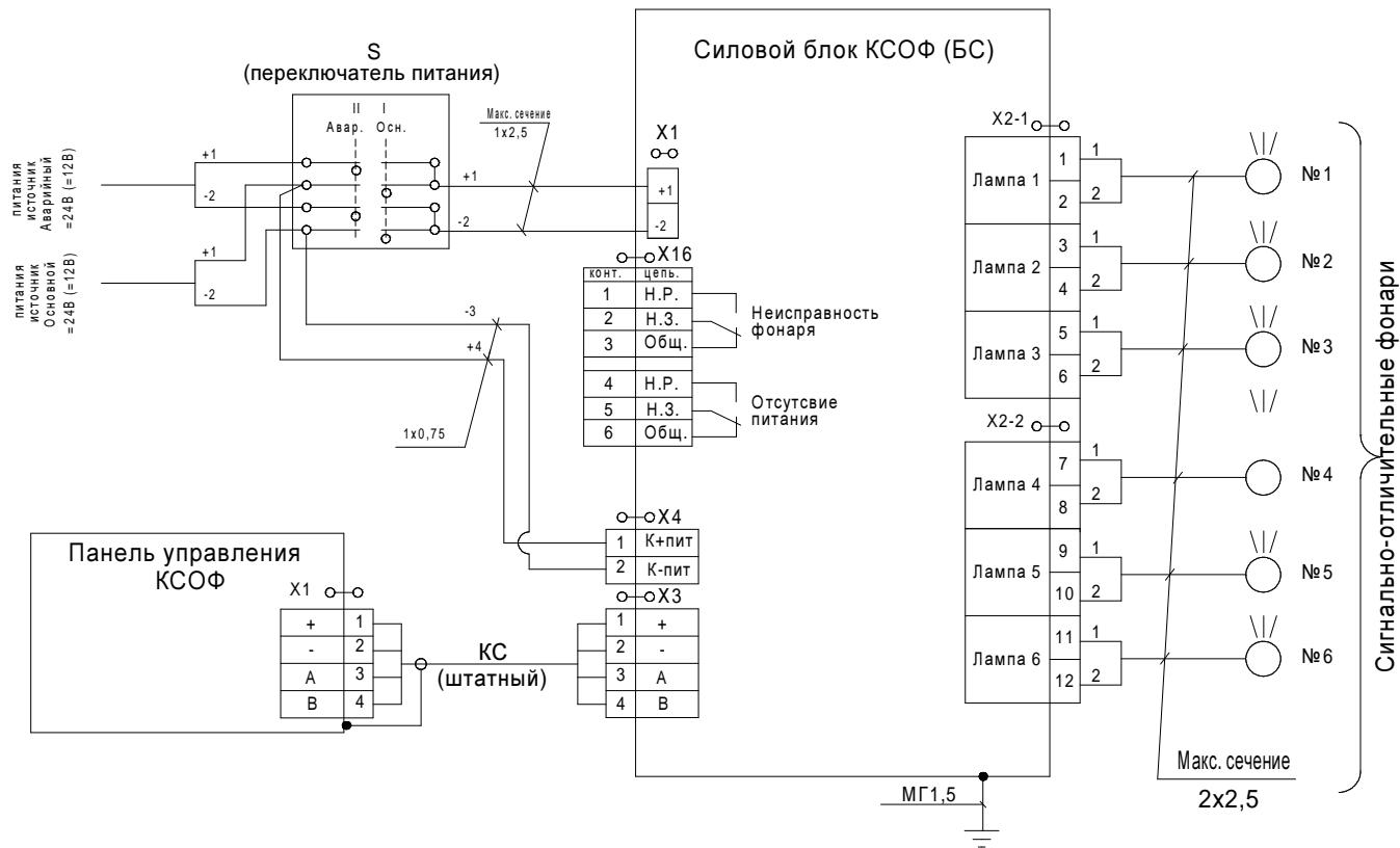
Схема электрическая соединений
