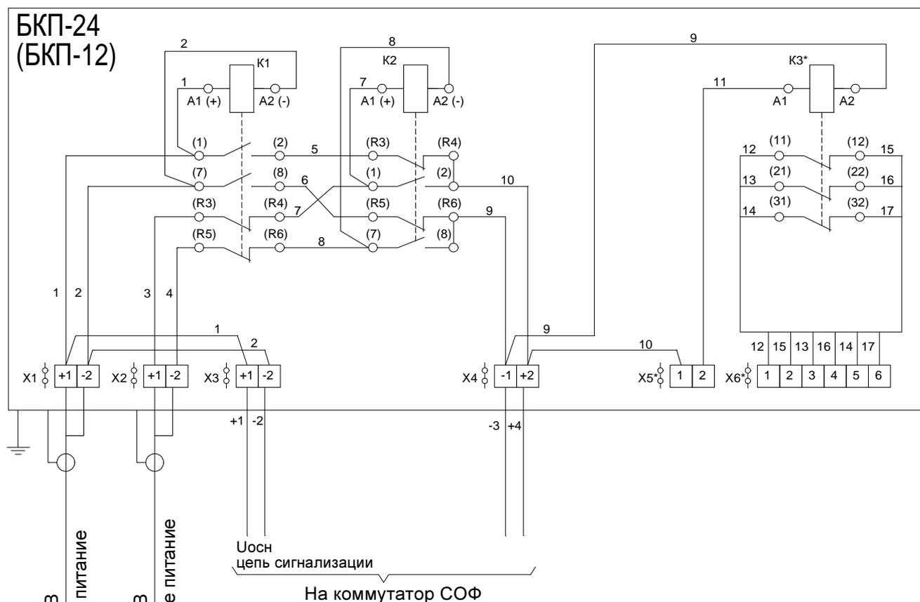
Клеммы клеммника X3 со встроенными предохранителями 0,5А
