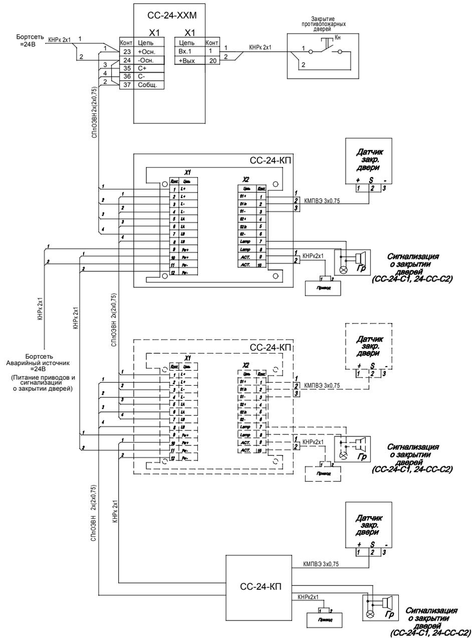
**Примечание:** Поставка датчиков, кнопки «Закрытие противопожарных дверей», поста «Сигнализация о закрытии противопожарных дверей» оговаривается при заказе.
