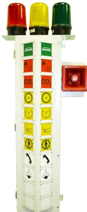
Пост СС-24-СК9М, СС-24-СК11 (колонка светозвуковая) на 9 и 11 сигналов соответственно. Маяки и подсветка сигналов выполнены на светодиодах, что обеспечивает низкое электропотребление. Степень защиты IP44, вес 18 и 26 кг.
